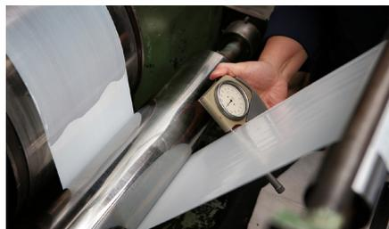
Материалы фторопластовые пленочные адгезионноспособные применяются в качестве защитных, антифрикционных и антиадгезионных покрытий, а также в качестве пазовой межслойной и межобмоточной изоляции.
